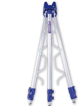
コンパクト三脚三段式 Compact rod stand(3 sections) オープン価格 Open price 脚の長さ:53~112cmまで調節可能 Weight:600g 材質:アルミニウム
