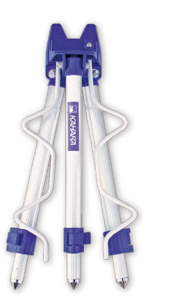
コンパクトミニ三脚 Compact rod stand(2 sections) オープン価格 Open price 脚の長さ:28~44cmまで調節可能 Weight:400g 材質:アルミニウム
